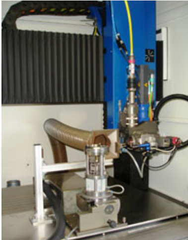
Arbeitsraum der universellen Laser- maschine «LASMA 1054» für Schweiss- und Schneidaufgaben im 2D- und 3D- Bereich.
